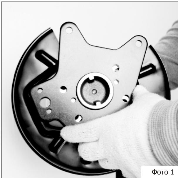
Для ВАЗ 2108 – 2115, Приора переходная пластина и кожух устанавливаются между осью ступицы и балкой (фото 2). Ступицу с оси демонтировать не нужно!
